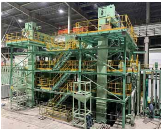
Obr. 2: Gigantické rozměry: Vertikální tryskací zařízení je 14 metrů vysoké a stojí ve dva a půl metru hluboké jámě. Čtyři inspekční plošiny včetně přístupových schodů dodávají systému ještě působivější vzhled.
