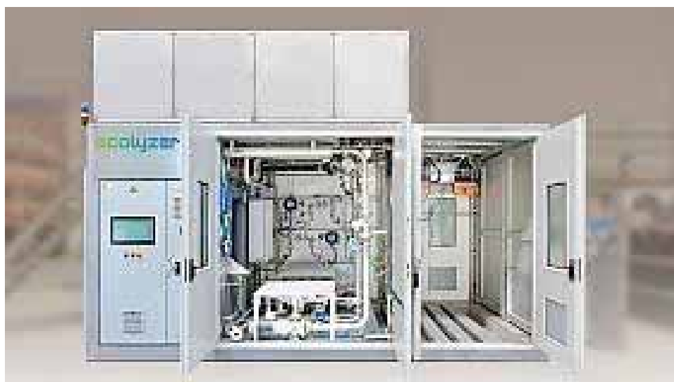
Obr 3.: Zkušební zařízení EcoLyzer - První řešení v této oblasti bylo dokončeno v září 2023 pomocí zkušebního zařízení pro alkalickou tlakovou elektrolýzu
