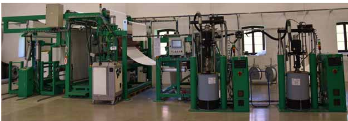
Převíjecí laminační linka pro bodovou, plošnou a sprejovou aplikaci tavných a disperzních lepidel
