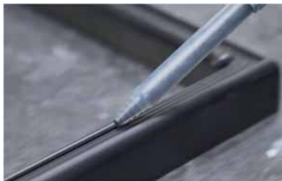
Aplikace elastického lepidla na bázi 2K silikonu
