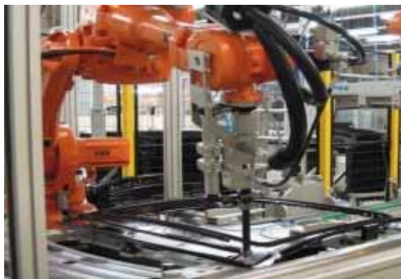
Plně automatizovaná linka lepení autoskel
