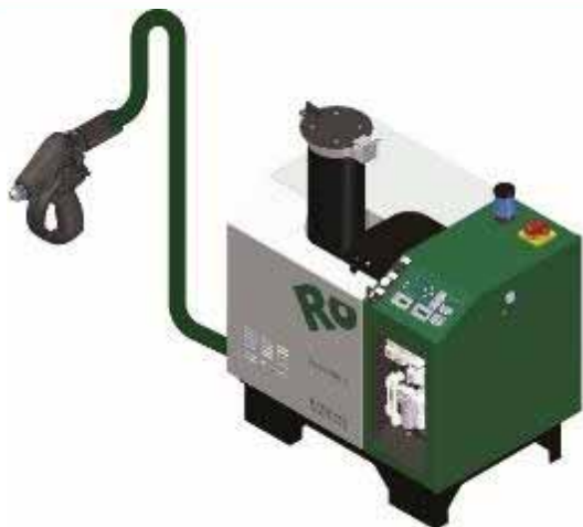
Ruční aplikační zařízení Robatech pro patrony tavného reaktivního PUR lepidla
