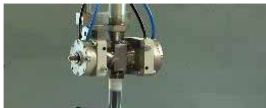
Volumetrické dávkování pastovitěho lepidla
