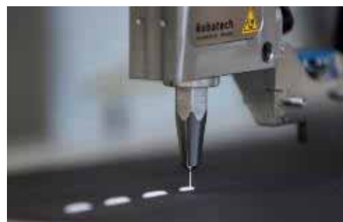
Přesný volumetrický pístový dávkovač
