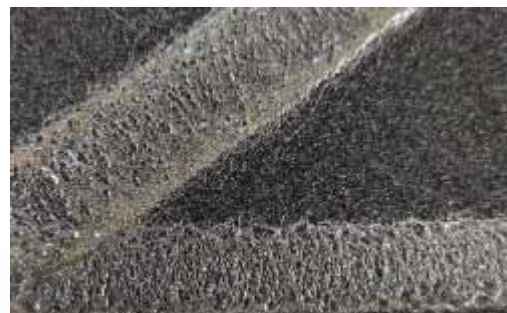
Přesný sprejový nános tavného lepidla
