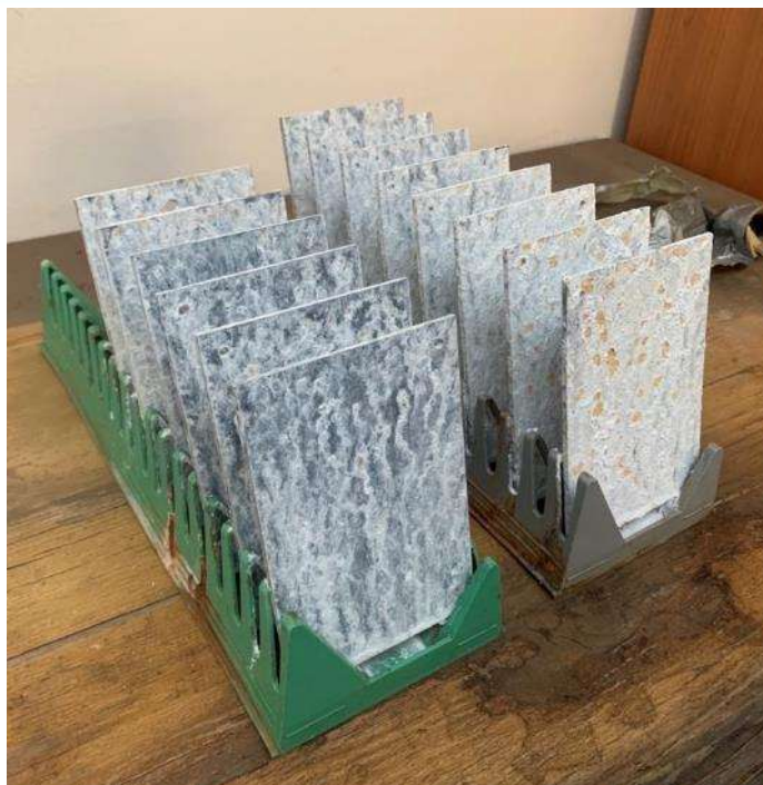
Obr. 3: Žárově zinkované vzorky po korozní zkoušce.
