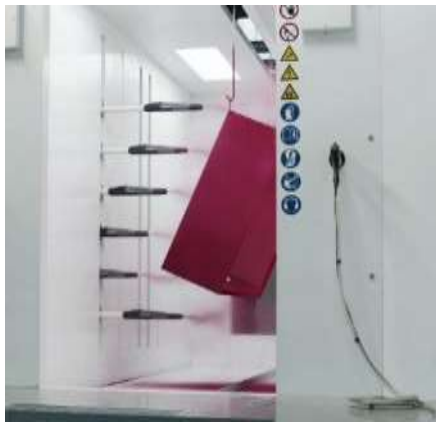
Výhody 3D lakování lze v plném rozsahu využít pouze se současným a kontinuálním pohybem ve směru Y a Z.
