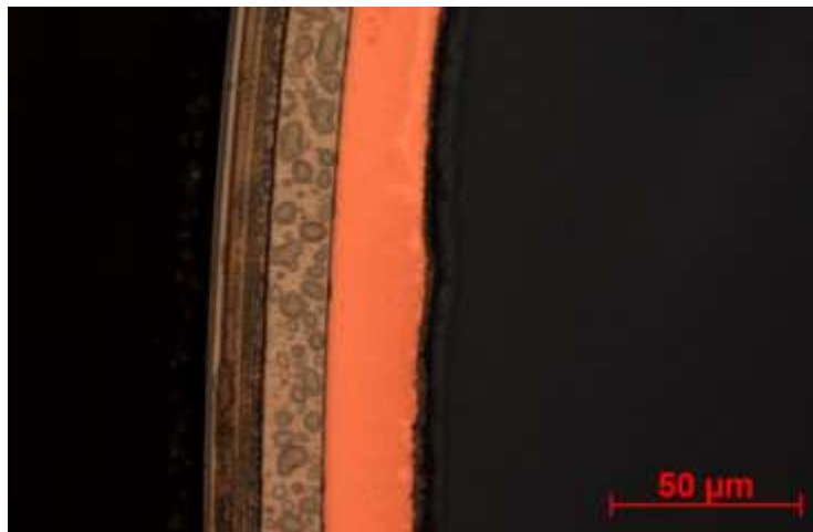
Obr. 1: Příklad galvanicky naneseného kovového povlaku na povrchu dílu z ABS. Zprava – povrchová vrstva polymeru po naleptání kyselinou chromsírovou a aktivaci pomocí palladia, zde téměř nezatelná vrstva chemického niklu a imerzní mědi, dále vrstvy galvanické mědi, galvanického niklu (pololesklý, lesklý, mikroporézní) a finální vrstva chromu. Leptáno, zvětš. 500x, světlé pole.
