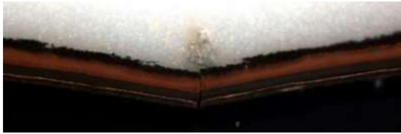
Obr. 2: Příklad zobrazení řezu vadou, vycházející z vměstku v základním materiálu (ABS). Optická mikroskopie, leptáno směsí kyseliny dusičné a octové, zvětš. 200x, Nomarski.
