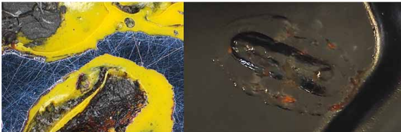
Obr. 20: Mikroskop. výbrus defektního svaru, napravo lakovaný svar po 15c testu PV1210
