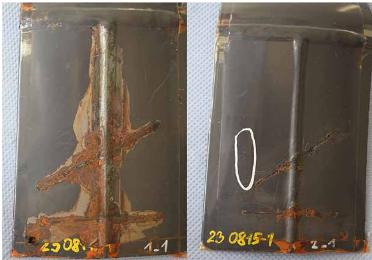
Obr. 19: PES práškový nátěr v oblasti svarů na ZrIV a ZnP pasivaci, Volvo cyklický test po 6t
