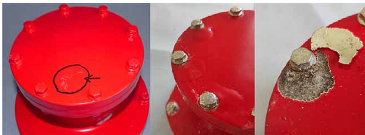
Obr. 18: Stav EP+PUR lakované Al příruby po 240 h AASS testu. Šrouby s lakem a bez laku
