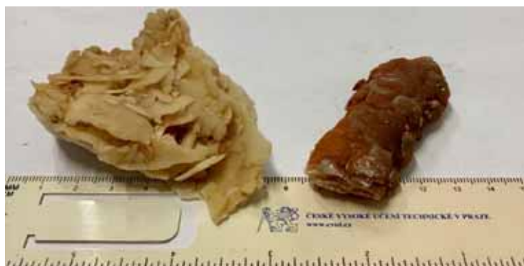
Obr. 1. Úsady minerálů z vnitřních povrchů teplosměnných ploch
