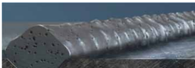
Obr. 5: Ostrohranný a nepravidelný svar
