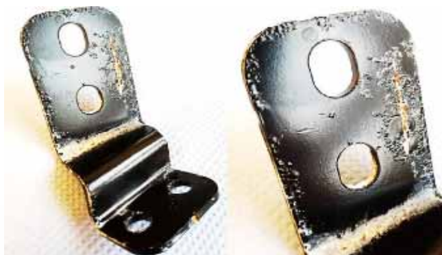
Obr. 15: Ukázka duplexního systému galv. Zn + KTL (ofl-x632) po testu PV1210 (42 dnů)
