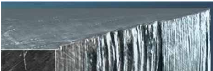
Obr. 3: Ukázka struktury nepravidelného profilu s okujemi
